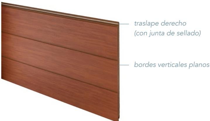
Los bordes del AWP 3030 se traslapan en los bordes superior e inferior únicamente, y el borde superior incluye una junta de sellado. Los bordes verticales del AWP 3030 son planos, por lo que se requiere un respaldo de sellado o una moldura metálica y solo permite una disposición apilada. *Los bordes planos y verticales nunca se juntan directamente, ni se escalonan. El AWP 3030 puede instalarse horizontal o verticalmente.*
