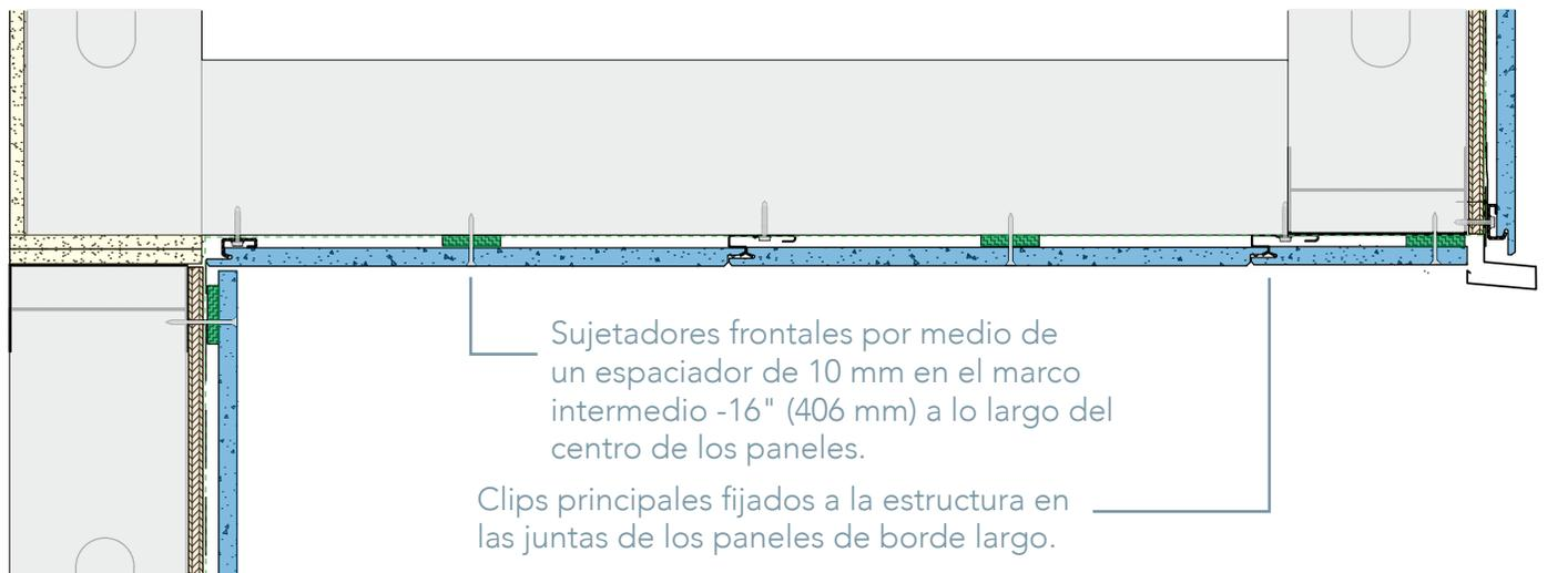
En el caso de los paneles cortados/hilada terminal de menos de 10" (254 mm) de ancho, no se necesitan los fijadores frontales del centro.
