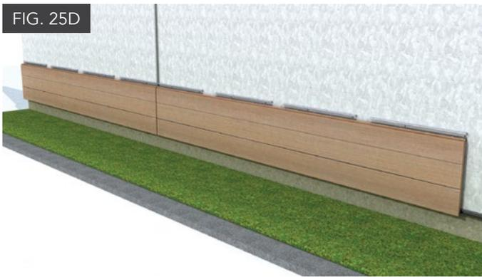
*Moldura en H como el detalle de la junta vertical del panel AWP-3030*
